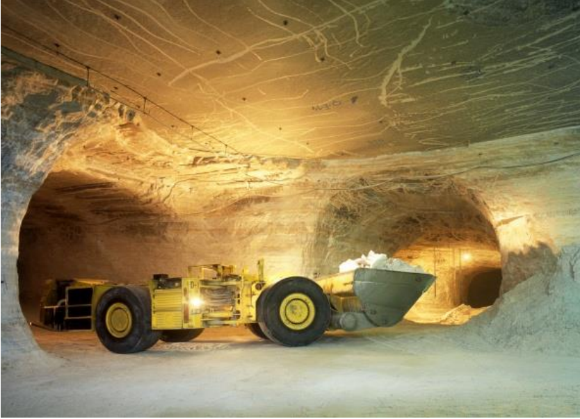
Mit Baggern wird das gesprengte Salz unter Tage abgefahren. Bis zu 17 Tonnen Rohsalz kann dieser Lader auf einmal transportieren. Foto: K+S Aktiengesellschaft
