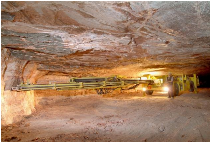
Computergesteuerte Bohrwagen treiben mit höchster Präzision Löcher in das Gestein, die anschließend mit Sprengstoff befüllt werden. Foto: K+S Aktiengesellschaft
